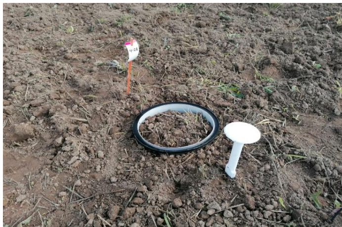
Gredzens un augsnes mitruma/temperatūras sensors
